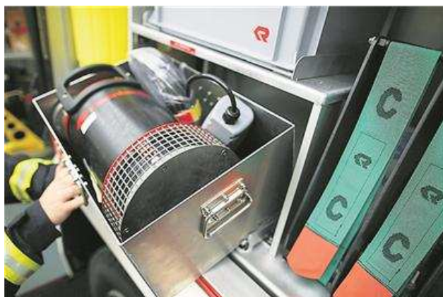
Bei Hochwasser unerlässlich: Die Tauchpumpe schafft 800 Liter in der Minute.
